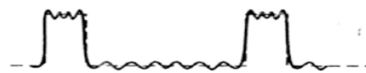
Sl. 5. Uticaj propusnog opsega na oblik digitalnog signala
